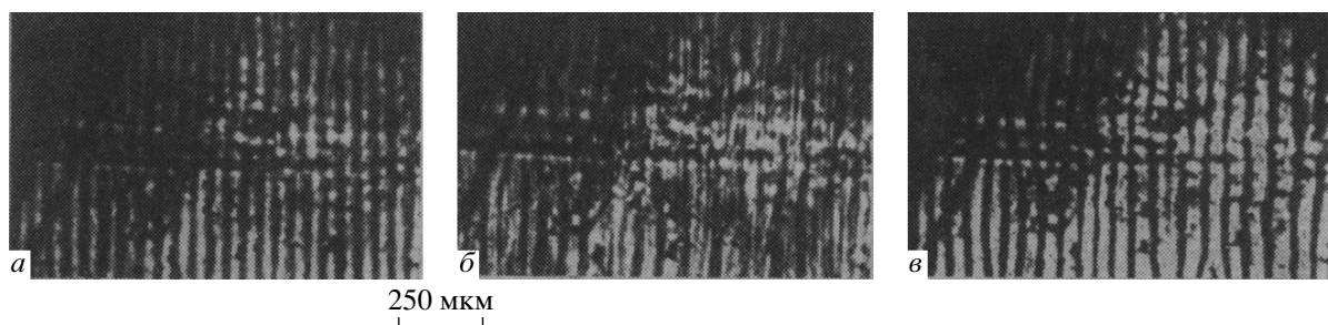
Рис. 2. Доменная структура в bc -пластине \text{ErFeO}_3 при T = 1.71 К в магнитном поле \mathbf{H} \parallel c : H = 0 (а), 3.1–3.3 кЭ (б), 3.35 кЭ (в)
