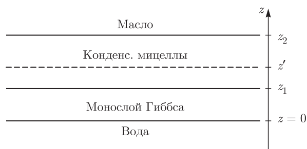
Рис. 1. Структура адсорбционной пленки на межфазной границе масло–вода, z_1 — толщина монослоя Гиббса, z' — положение плоскости наименьшего сближения мицелл с межфазной границей и z_2 — диффузная граница слоя конденсированных мицелл с объемом неполярного растворителя
